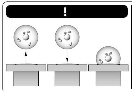
**D** Bei Stillstand der Glaskugel bitte bei eingeschalteter Pumpe die Kugel kurz anheben und wieder absetzen.
