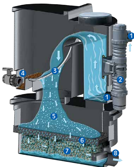
sera KOI Professional 24000 jezírkový filtr s možností propojení dvou sera UV-C-systému 55 Wattů
